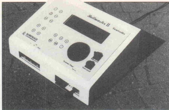
Eine Weltpremiere: Der Bellmaster II, der sowohl via Midi als auch über eingespeicherte Sequenzen ein großes Glockenspiel steuert.
