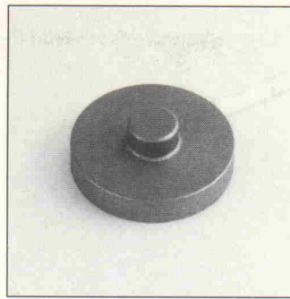
Bild 4. Miniaturdruckkraftsensor von Burster.
