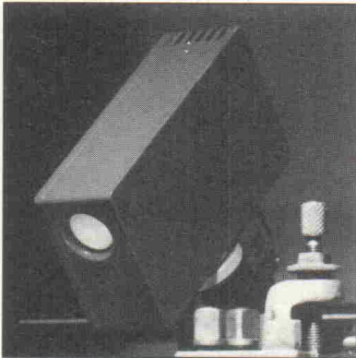
Bild 2. Das Radar-Sensor-System betrachtet immer ein Flächenelement des Werkstücks für eine integrale Meßwertaufnahme.
